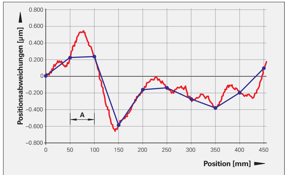
Abbildung 2: Korrekturpunkte für abschnittsweise lineare Fehlerkorrektur
